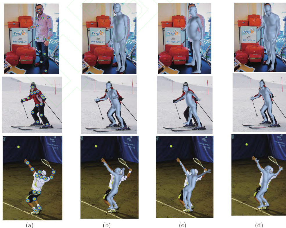
图 8 各类型方法在 RGB 姿态估计上的对比. (a) 原始 RGB 图像以及关键点; (b) HMR 神经网络模型结果; (c) 数值 IK 的结果; (d) MNN-IK 模型优化后的结果
